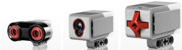
Датчик касания Ультразвуковой датчик Датчик цвета
